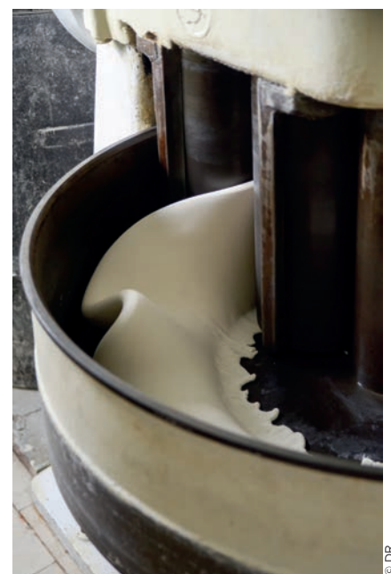
▲ Refinadora, brie verticale, cette machine à raffiner et indispensable dans les fournils de la plupart d'Espagne (les deux Castilles, Andalousie, Estrémadure, etc.). La pâte, ferme à l'extrême au commencement, finit par se transformer en une substance magique à des formes infinies.
